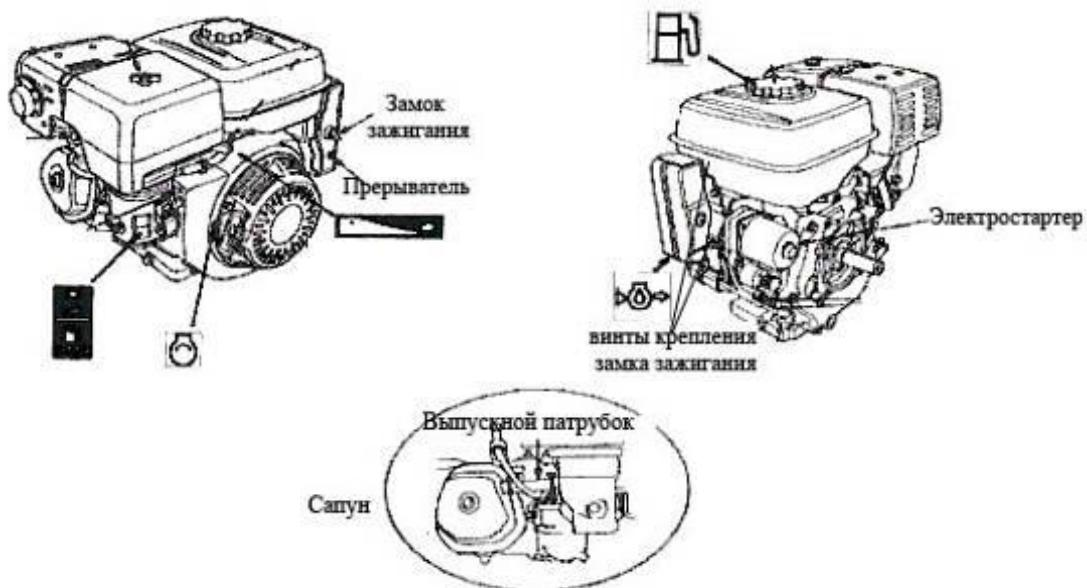
**Замок зажигания может быть не смонтирован на двигателе. Установите замок зажигания при помощи 2-х винтов, соедините провода от замка и двигателя, согласно цвета проводов.**
