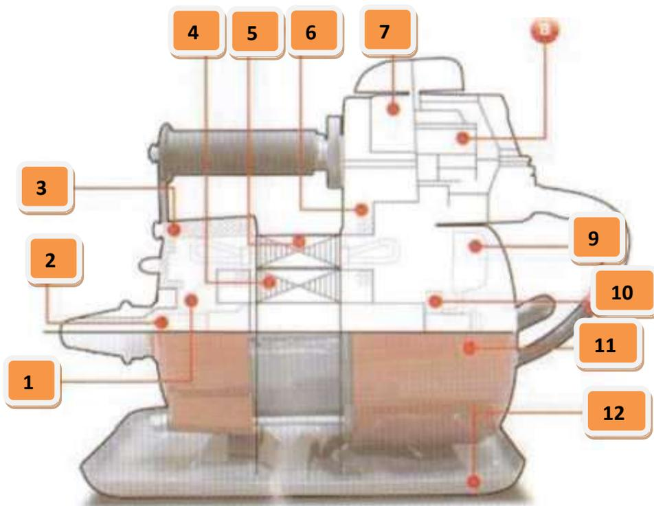
Рис 2. Электродвигатель вибратора
