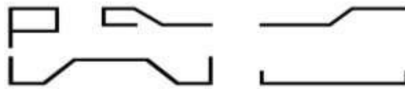
Рис. 2 - Формы изгиба арматуры
