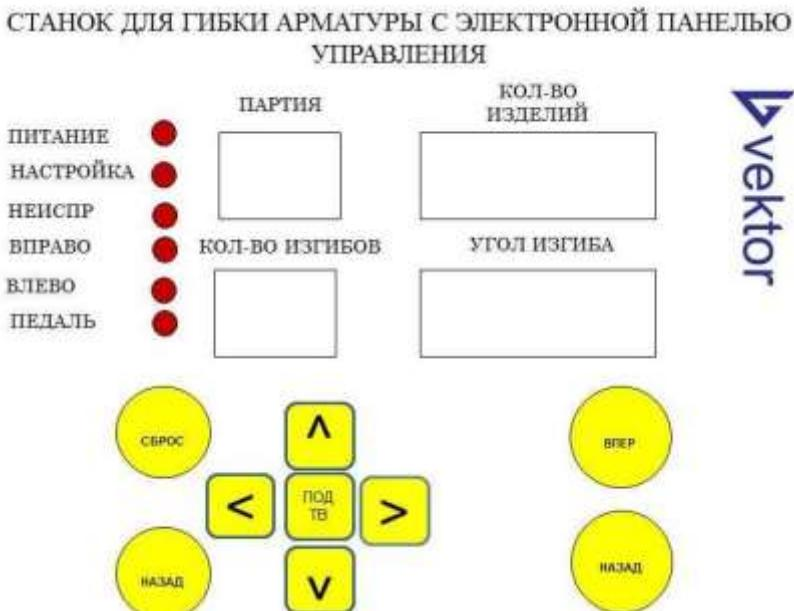
(Рис. 2 Электронная панель управления)
