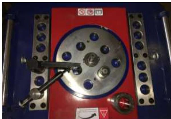
Осуществляем пробный запуск в автоматическом режиме, проверяем правильность выбранного угла.
