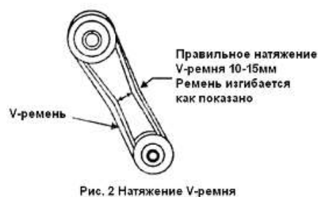
Рис. 2 Натяжение V-ремня
