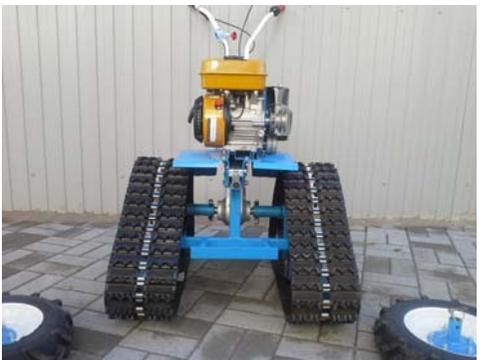
7. Мотоблок на гусеничном приводе готов к работе.
