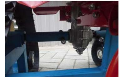
4. Установить переднюю рамку на корпусе ГУСЕНИЧНОГО ПРИВОДА. До упора затянуть болт крепления рамки.
