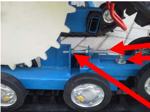
5. По необходимости натяжку гусеницы производить натяжником, перед этим ослабив гайку. После натяжки, гайку затянуть до упора и законтрогаить натяжной болт (провис гусеницы max 25мм)
