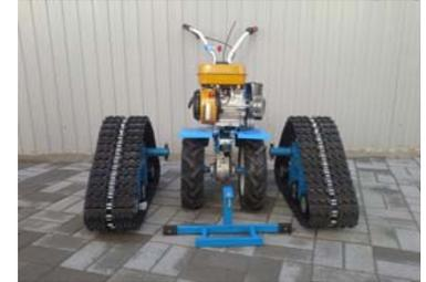
2. Совмещаем отверстие на валу редуктора мотоблока с отверстием на валу на ГУСЕНИЧНОМ ПРИВОДЕ и вставляем болт.
