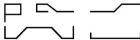
Рис. 5 Формы изгиба арматуры
