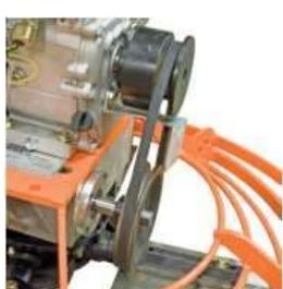
6. Далее установите кронштейн кожуха ременной передачи и закрепите с помощью двух болтов, идущих в комплекте.
