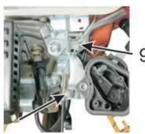
3. Закрепите конец троса газа, пропущенного сквозь стойку, на приводе дросселя согласно рисунку. Для выполнения этой операции, возможно, потребуется снять рукоять привода дросселя.
