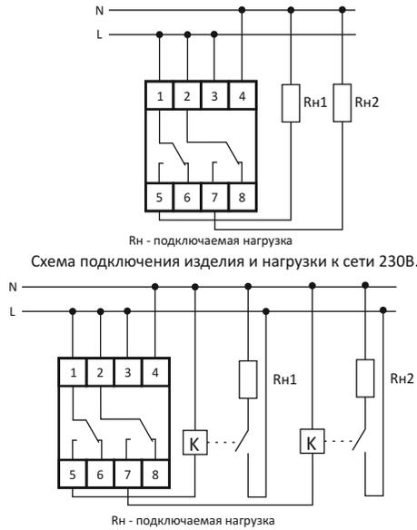
Схема подключения изделия с использованием контактора ток нагрузки более 16А.
