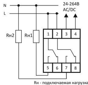
Схема подключения изделия и нагрузки, питающихся, от разных источников.
