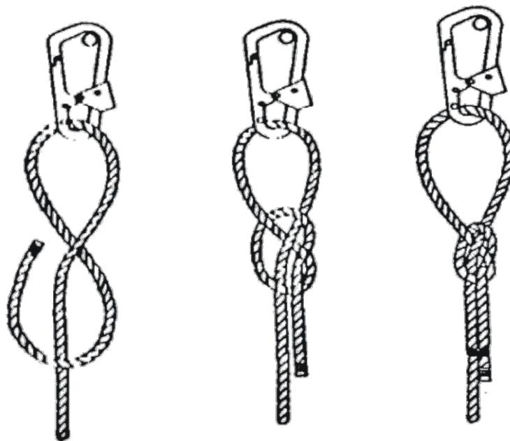
Закрепление концов фалов производится узлом «затягивающийся огонь» (на некотором расстоянии от конца каната затягивают узел восьмерку, после чего ходовой конец каната пропускают в верхнюю петлю восьмерки и затягивают узел).
