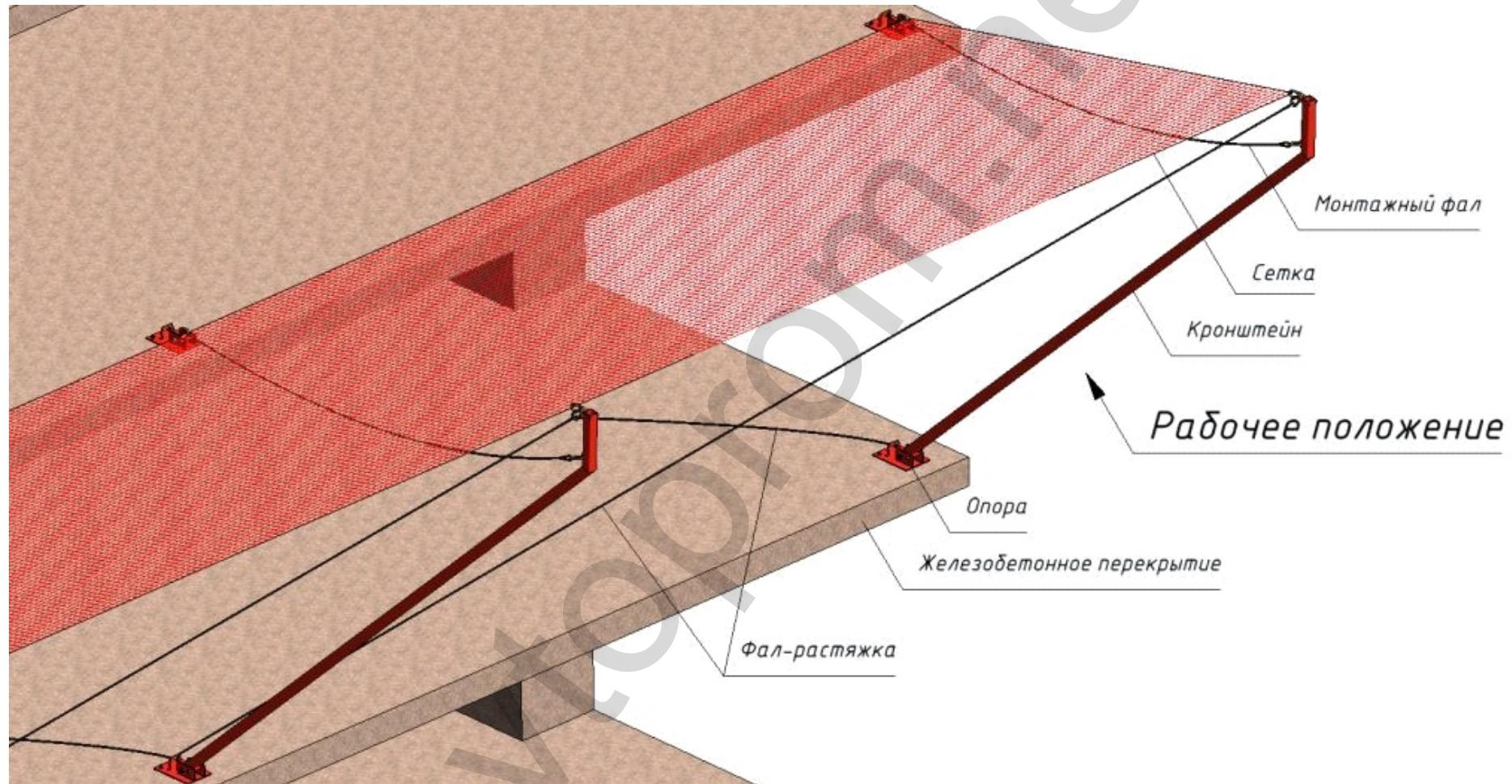
16. Монтаж конструкций следующего участка производится в аналогичной последовательности. По окончании монтажа опускаются следующие 2-4 кронштейна.
