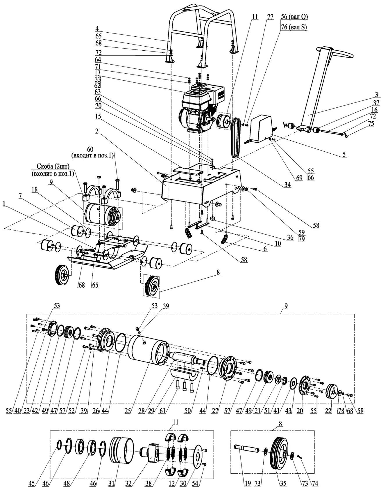
Рисунок 9 – Компоновка виброплиты
