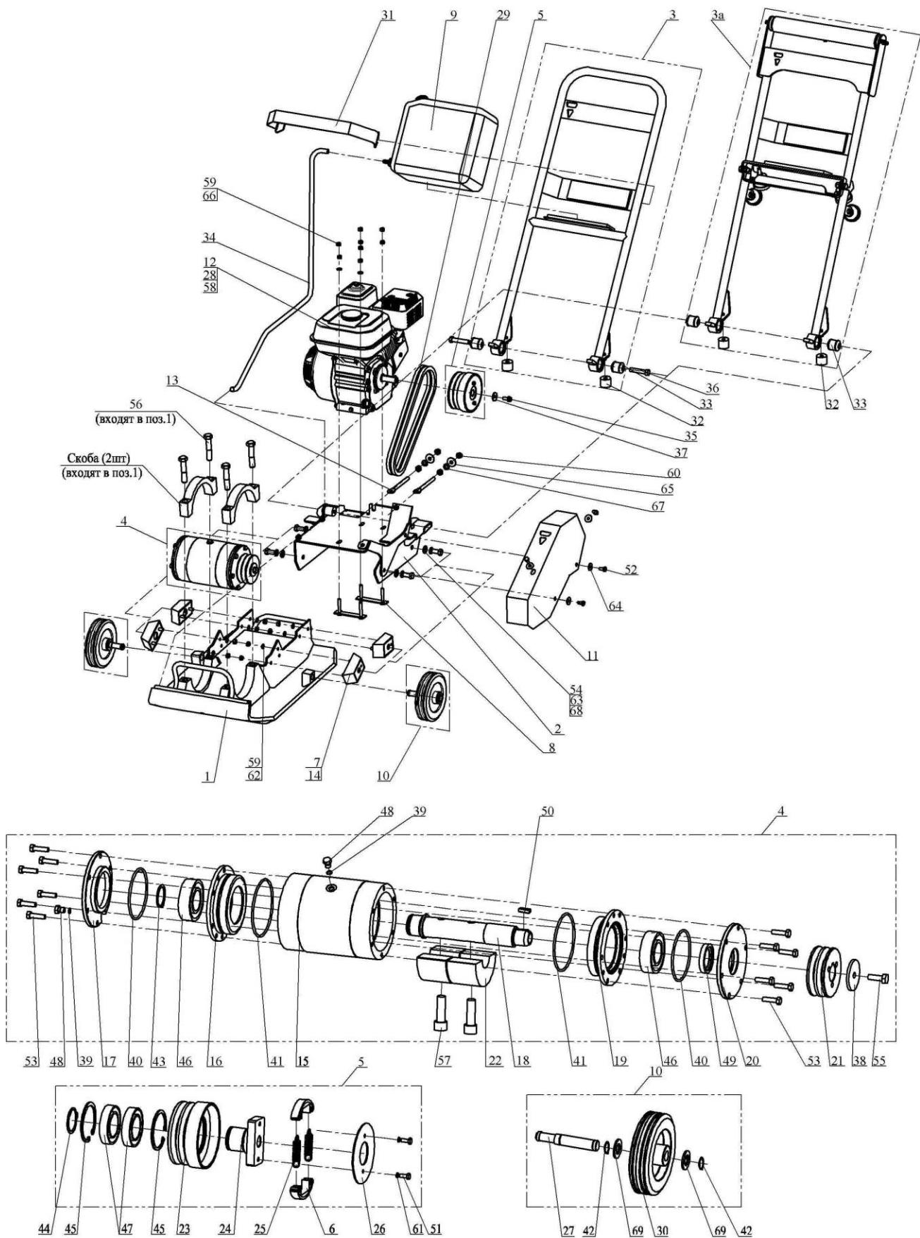
Рисунок 8 – Компоновка виброплиты
