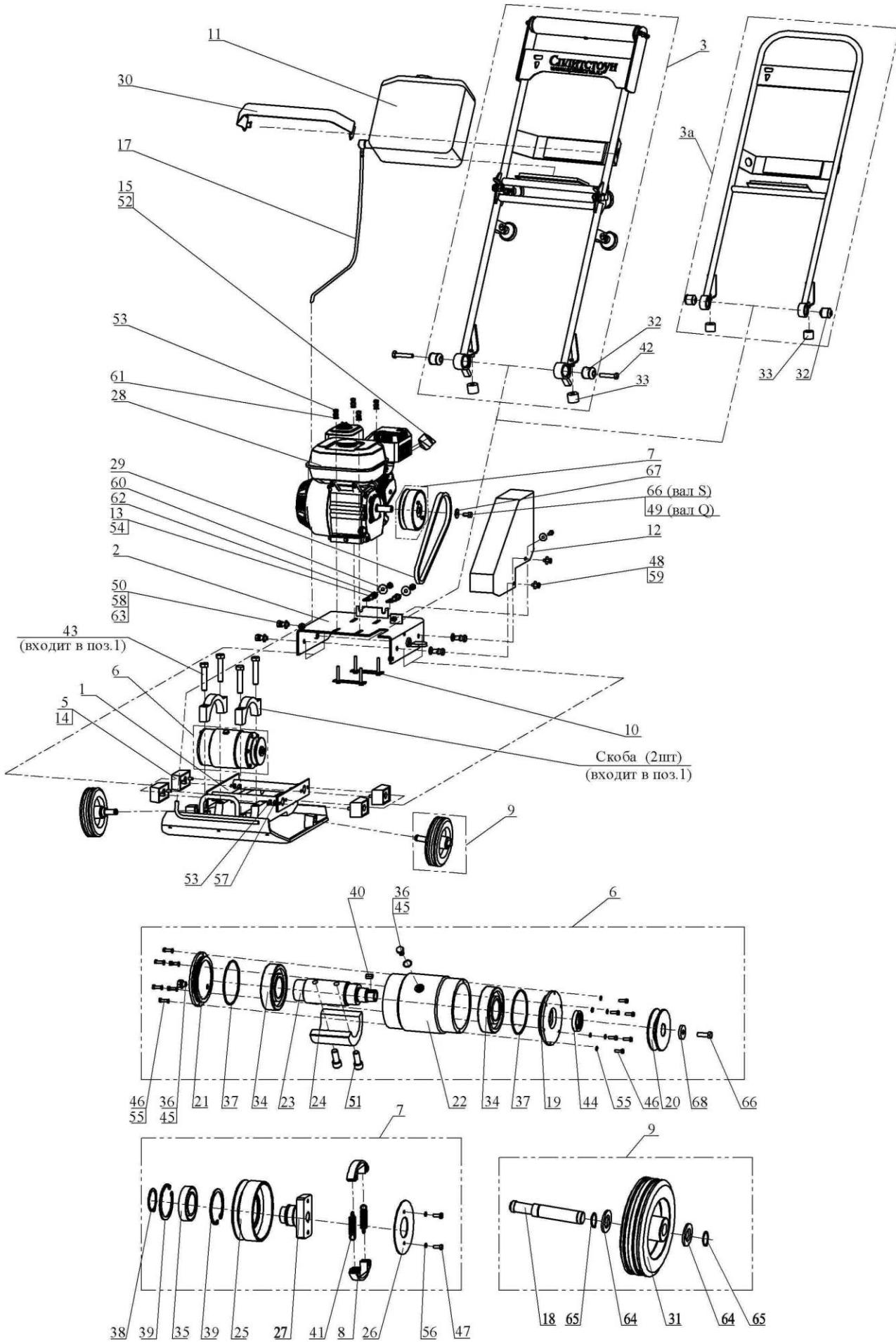
Рисунок 8 – Компоновка виброплиты
